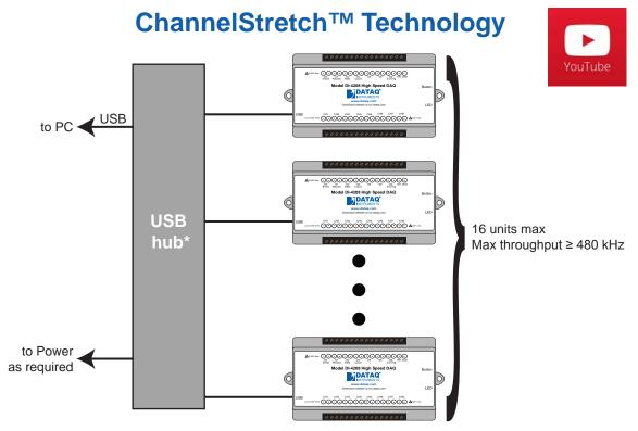
\*DATAQ Instruments 7-port USB hub (part number 2000310). Cascade for a higher port count. DATAQ 中国总代理 - 北京康泰电子有限公司 • Tel: 010-62329030 • Email: sales@quatronix-cn.com • www.quatronix-cn.com
